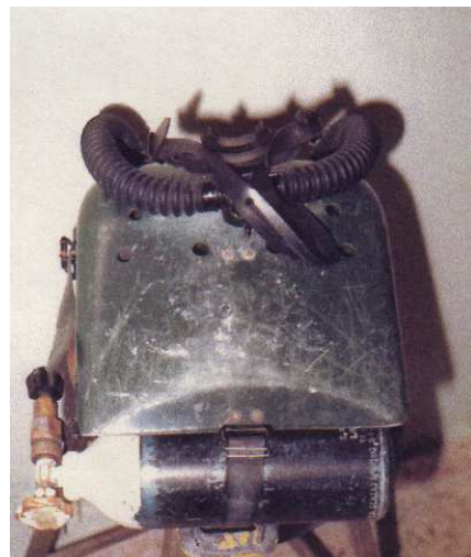
Fig.2.6. Equipo respiratorio con circuito cerrado de O_2 ( Cirilo Martínez ).
