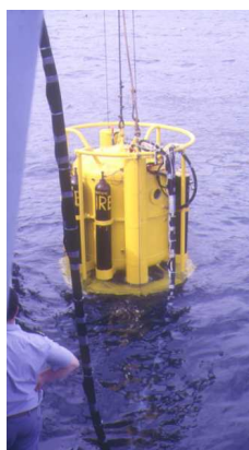
Fig.10.1. Campana de profundidad (JM G-Cubillana,
